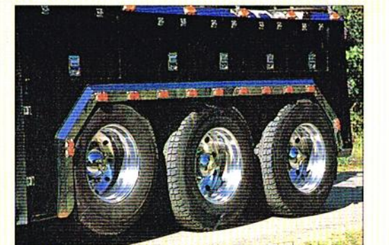
Zusätzliche Stütze: Nur unter schwerer Last kommt die dritte Achse auf den Boden.
