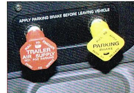
Uriges Relikt: Steuerventile für Bremse und Anhänger.
