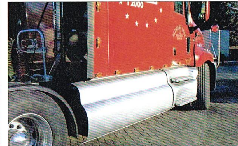
Geschützte Flanke: Die Verkleidung reicht bis zur Hinterachse.
