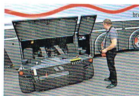
Im passgenauen Unterbau führt der Kenworth seinen eigenen Stapler mit.
