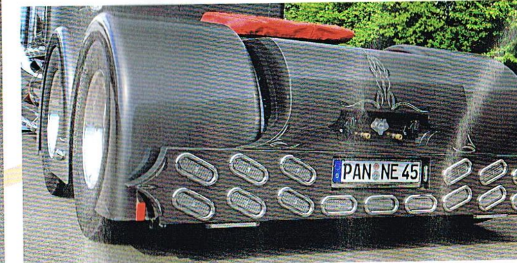
Die Anschlüsse für den Auflieger wanderten von der Kabinenrückwand ans Heck.
