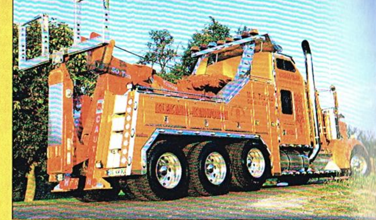
Erweiterung: Die Liftachse bekam der Truck erst in Deutschland.
