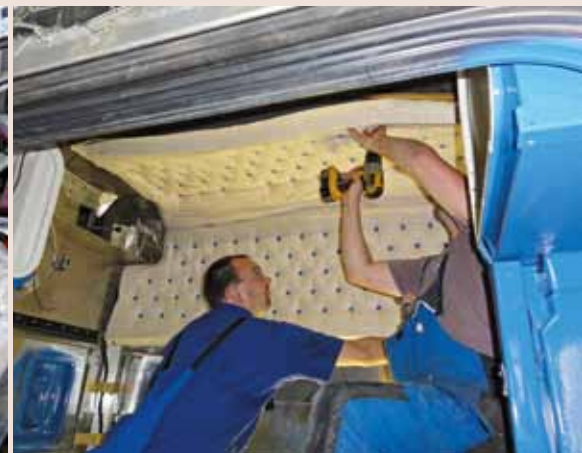
In die fertigen Verkleidungen baute Klekamp einen „Sternenhimmel“ mit mehreren Dutzend Dioden ein
